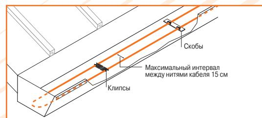
Рисунок 4.9. Схема крепления нагревательного кабеля в широком желобе
